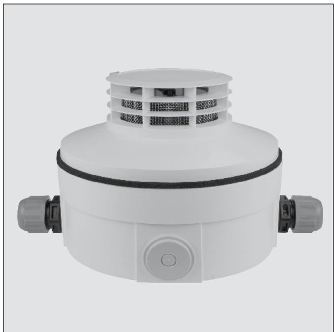
Der MMD 130 Ex-i ist ein eigensicherer Rauch- und Wärmemelder zum Einsatz in explosionsgefährdeten Bereichen der Zonen 1 und 2 mit der Schutzzart II 2 G Ex ib IIC T4. Der MMD 130 Ex-i arbeitet mit Streulicht und erkennt frühzeitig Schwell-, Glimm- und offene Brände mit und ohne Rauchentwicklung.
